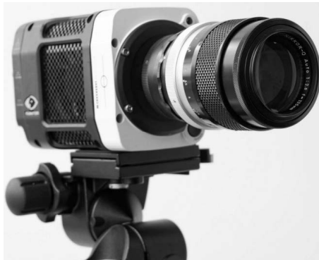
3.16 pav. Didelės spartos vaizdo tyrimų kamera „Phantom Miro 110“. Kameros didžiausias filmavimo dažnis yra 1630 Hz esant 1280x800 skiriamajai gebai. Didesnis filmavimo dažnis gali būti pasiektas sumažinus skiriamąją gebą, pvz., 5090 Hz parinkus raišką 640x460 (Payton, & Hudson, 2018)
